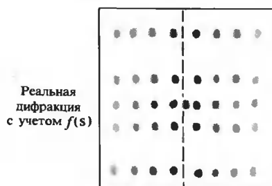
РИС. 13.11. Рассеяние рентгеновских лучей, наблюдаемое в лаборатории в случае двумерной периодической решетки, плоскость которой перпендикулярна направлению падающего пучка. Левая и правая половины рисунка иллюстрируют картины дифракции, получающиеся на цилиндрической и сферической пленках соответственно. A. Геометрии съемки. Б. Слоевые линии, появляющиеся вследствие периодичности a решетки. В. Слоевые линии, обусловленные периодичностью b решетки. Г. Реально наблюдаемое рассеяние, которому соответствует произведение функций, представленных на фрагментах Б и В , и атомной картины рассеяния, показанной на рис. 13.9,Б.
