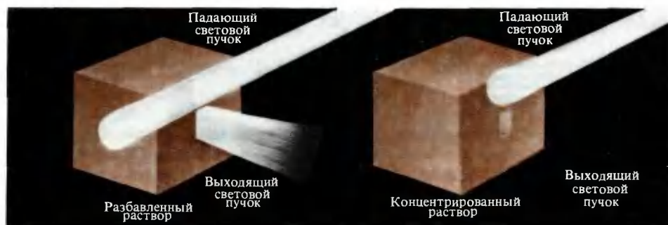
РИС. 8.13. Измерение флуоресценции в стационарных условиях. А. Схематическое изображение флуоресцентного спектрометра. M_1 — монохроматор возбуждения, M_2 — монохроматор эмиссии, L — источник света, РМ — фотоумножитель, S — образец. Б. Изображение кюветного отделения в увеличенном виде, иллюстрирующее эффект внутреннего фильтра.
