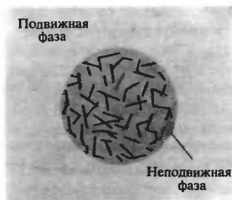
РИС. 12.14. Схематическое изображение зерна геля, используемого в распределительной гель-хроматографии. Растворитель снаружи зерен (подвижная фаза) занимает объем V_{\text{св}} . Растворитель, заполняющий пустоты в зернах (неподвижная фаза), занимает объем V_{\text{внутр}} . Матрица геля (показана темными линиями) занимает объем V_{\text{м}} , недоступный для растворителя.
