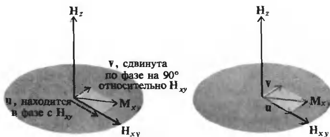
РИС. 9.6. Компоненты вектора \mathbf{M}_{xy} . Компонента \mathbf{u} находится в фазе с \mathbf{H}_{xy} , а компонента \mathbf{v} сдвинута на 90^\circ .
