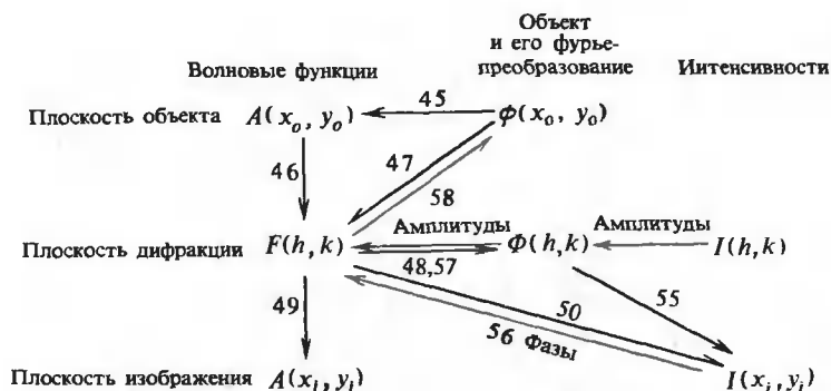
РИС. 14.15. Определение структуры с помощью электронного микроскопа. Показаны «взаимоотношения» между различными наблюдаемыми и вычисляемыми величинами. Числа около стрелок относятся к соответствующим уравнениям в тексте, с помощью которых можно провести указанные расчеты. Коричневыми стрелками отмечены те этапы расчета, которые проходит исследователь при решении структуры.
